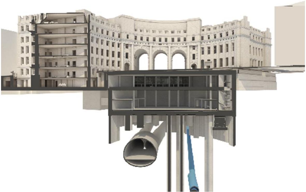
Şekil 20. Admiralty Takı'nın Altına İnşa Edilmesi Gereken Bodrum Katların ve Tak'ın Altından Ggeçen Metro Hattı ile Diğer Altyapıların YBM Modeli (2) [52]
